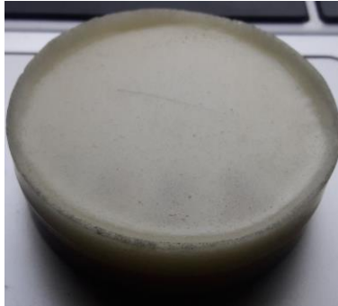
Gambar 3.13 Isolator sedikit void
