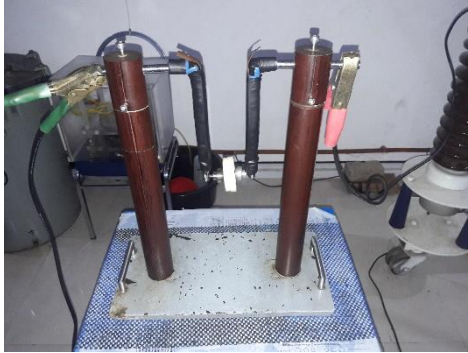
Gambar 3.15 Proses pengujian PD pada isolator
