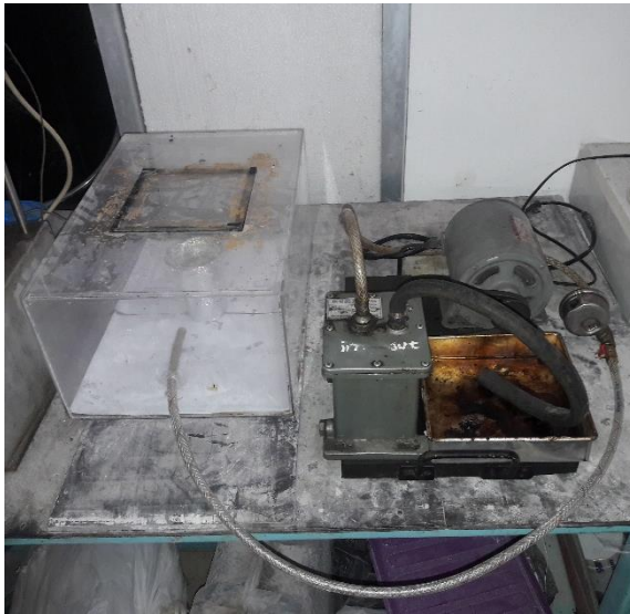
Gambar 3.3 Modul vakum sederhana
