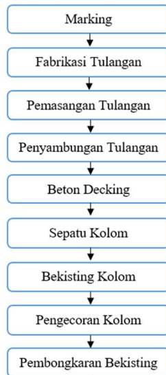
Bagan 3. 1 Pemasangan Pekerjaan Kolom
