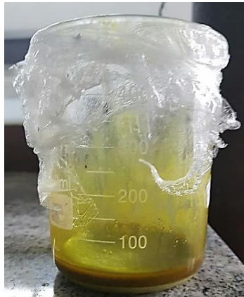
Gambar 4.2 Campuran larutan \text{PdCl}_2 dan serbuk Al-MCM-41/Keramik
