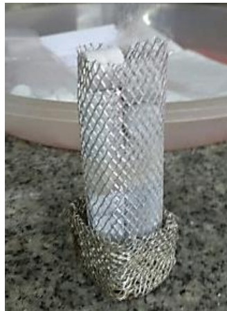
Gambar 4.19 Rangkaian pellet katalis pada kawat kasa
