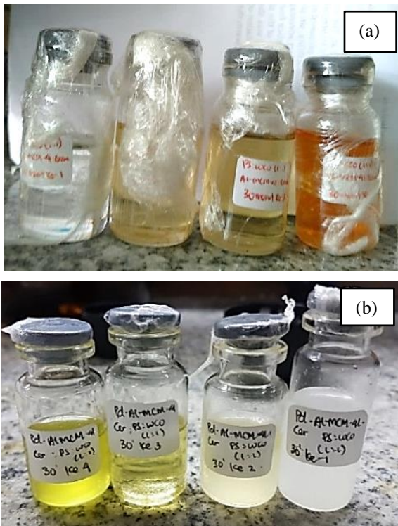
Gambar 4.20 Bahan bakar cair hasil perengkahan dengan (a) Katalis Al-MCM-41/Keramik (b) Katalis Pd/Al-MCM-41/Keramik
