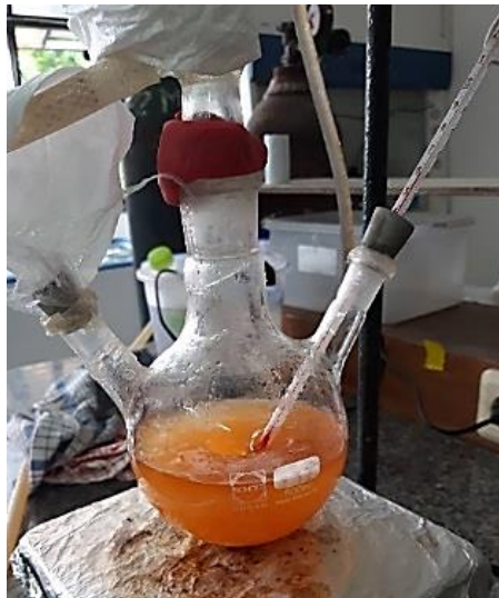
Gambar 4.16 Campuran minyak jelantah dengan campuran metanol dan katalis NaOH
