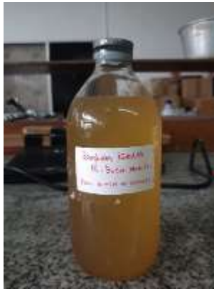
Gambar 4. 8 Hidrokarbon tahap 1 hasil perengkahan termal plastik PS
