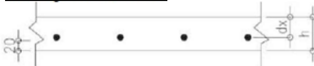
Gambar 4. 5 Sketsa Penulangan Pelat Sebelum Komposit
