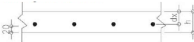
Gambar 4. 7 Sketsa Penulangan Pelat Setelah Komposit
