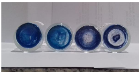
Gambar 4.11 Endapan hasil proses fotokatalisis.
