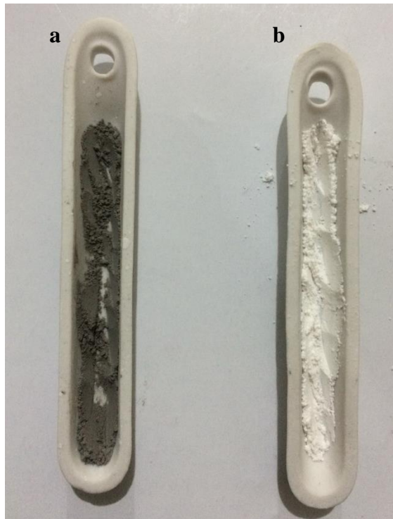
Gambar 4.1 NiO/ZSM-5(a) dan ZSM-5(b) setelah kalsinasi.
