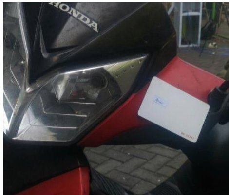
Gambar 4.16 Pemasangan RFID Tag pada Sepeda Motor
