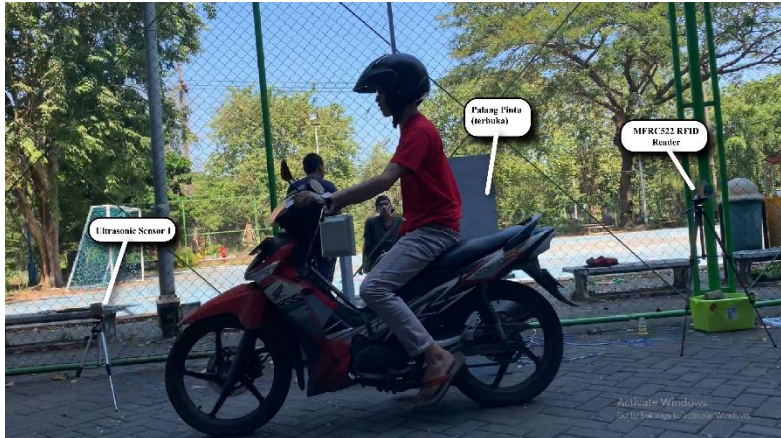
Gambar 4.23 Kendaraan Keluar dari Lahan Parkir dan Melewati Sensor Ultrasonic 2.
