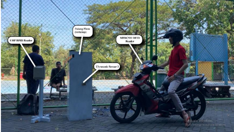
Gambar 4.21 Pengendara Menempelkan RFID tag ke MFRC522 RFID Reader.
