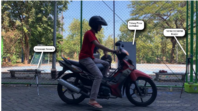
Gambar 4.19 Kendaraan Memasuki Lahan Parkir, Melewati Sensor Ultrasonic 2.
