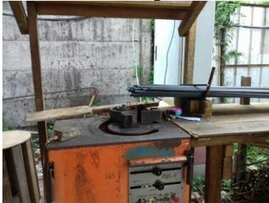
Gambar 5. 6 Pemotongan Tulangan
