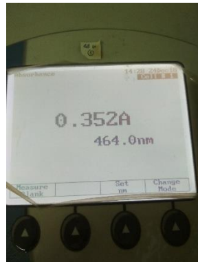
Pengukuran Absorbansi Larutan Indigosol Golden Yellow IRK 60 ppm (Setelah Adsorpsi 10 menit)
