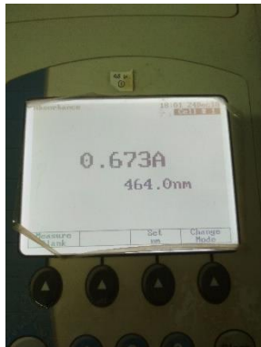
Pengukuran Absorbansi Larutan Indigosol Golden Yellow IRK 60 ppm (Sebelum Adsorpsi)
