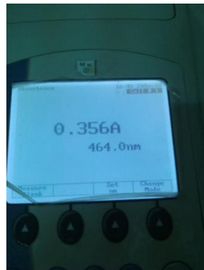
Pengukuran Absorbansi Larutan Indigosol Golden Yellow IRK 60 ppm (Setelah Adsorpsi 10 menit) - triplo
