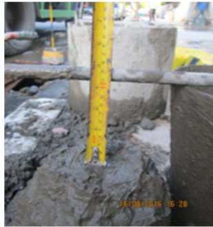
Gambar 29. Pengukuran hasil Uji Slump Sumber : Pribadi,Praktikum Beton Institut Teknologi Sepuluh Nopember, 2016
