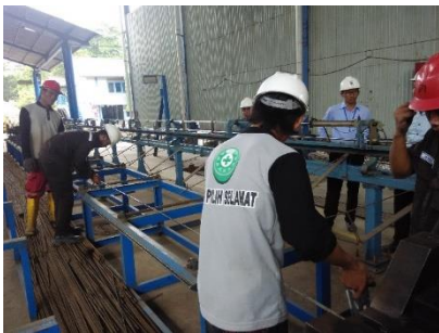
(a) Pemetongan tulangan PC bar (b) Perakitan tulangan PC bar dan spiral Gambar 3.11 Proses perakitan tulangan spun pile .
