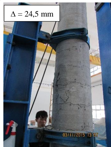
Gambar 4.44 Pengamatan visual benda spun pile dengan beton pengisi P_0 = 0,16f_c'Ag .
