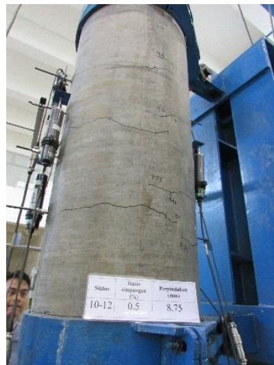
Gambar 4.39 Pengamatan visual benda uji S-DB-1.
