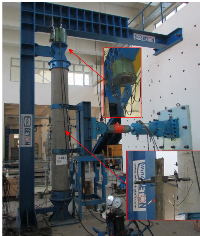
Gambar 3.20 Setting alat dan benda uji tes lentur siklik.
