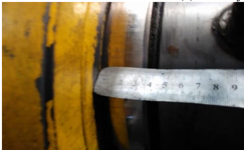
(b) Spun pile tes lentur monotonik
