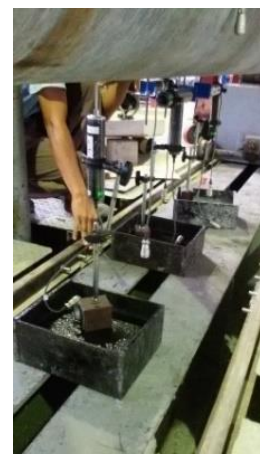
(b) LVDT vertikal
