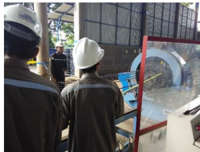
(a) Pemetongan tulangan PC bar (b) Perakitan tulangan PC bar dan spiral Gambar 3.11 Proses perakitan tulangan spun pile .
