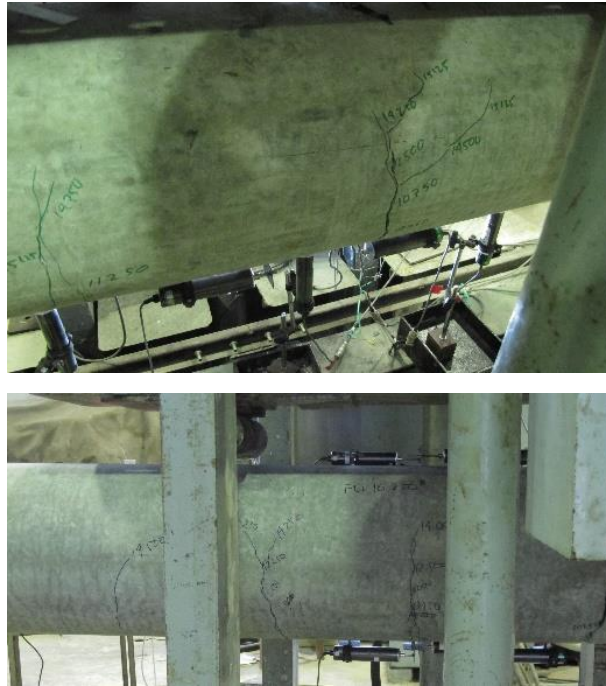
Gambar 4.15 Dokumentasi keruntuhan spun pile lentur monotonik.
