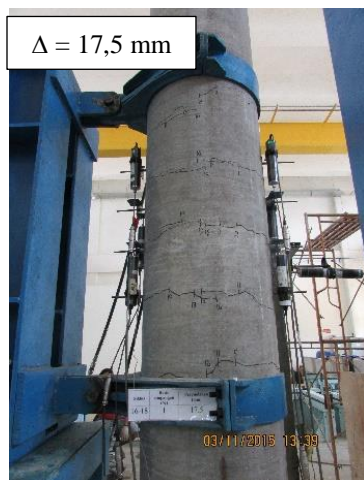
Gambar 4.44 Pengamatan visual benda spun pile dengan beton pengisi P_0 = 0,16f_c'Ag .
