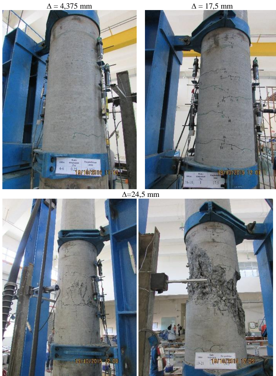
Gambar 4.35 Pengamatan visual benda uji S-TB-4.
