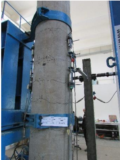
Gambar 4.40 Pengamatan visual benda uji S-DB-2.
