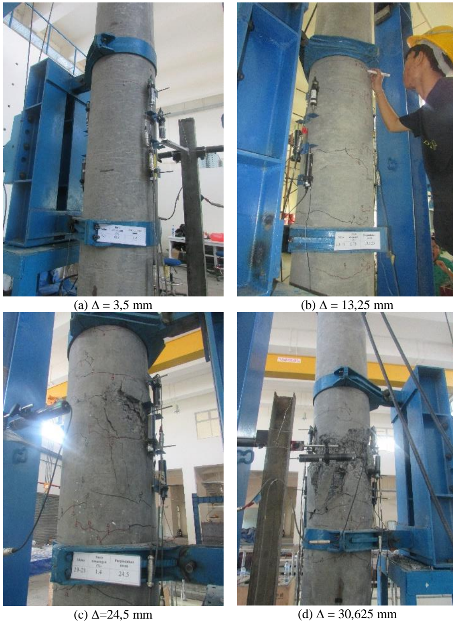
Gambar 4.34 Pengamatan visual benda uji S-TB-3.
