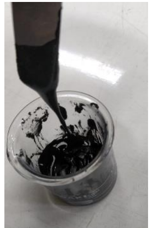
Slurry dengan kekentalan yang tepat
