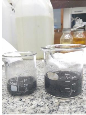
Pencucian anoda LIB bekas dengan DMC dan NMP
