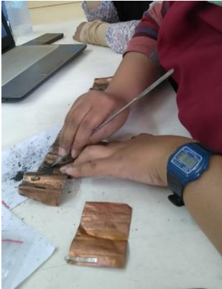
Pemisahan material anoda dari Cu foil
