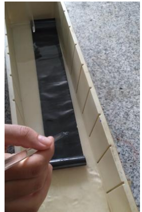
Pencucian anoda LIB baru dengan DMC
