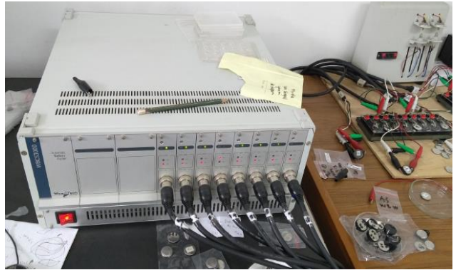
Pengujian voltametri siklik dan charge-discharge
