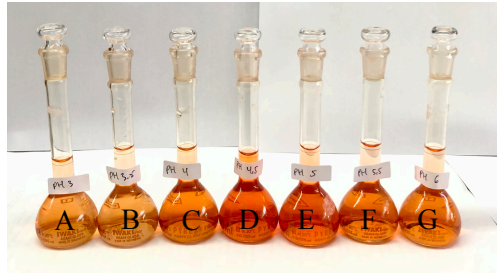
Gambar 4.9 Perubahan Warna Kompleks [\text{Fe}(\text{C}_{12}\text{H}_8\text{N}_2)_3]^{2+} dengan Pereduksi \text{NH}_2\text{OH}.\text{HCl} pada Penentuan pH Optimum yaitu A) pH 3 ; B) pH 3,5 ; C) pH 4 ; D) pH 4,5 ; E) pH 5 ; F) pH 5,5 dan G) pH 6.
