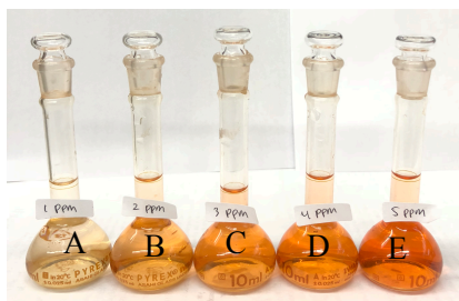
Gambar 4.6 Perubahan Warna dalam Pembuatan Kurva Kalibrasi pada Pereduksi \text{NaBH}_4 dengan Variasi Konsentrasi \text{Fe(II)} yaitu A) 1 ; B) 2 ; C) 3 ; D) 4 dan E) 5 ppm
