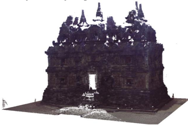
Gambar 4.7. Hasil Segmentasi Point Cloud Eksterior
