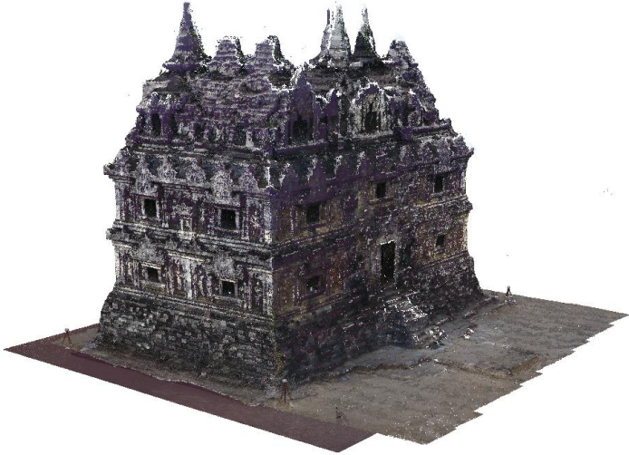
Gambar 4.10. Hasil Point Cloud Integrasi Eksterior
