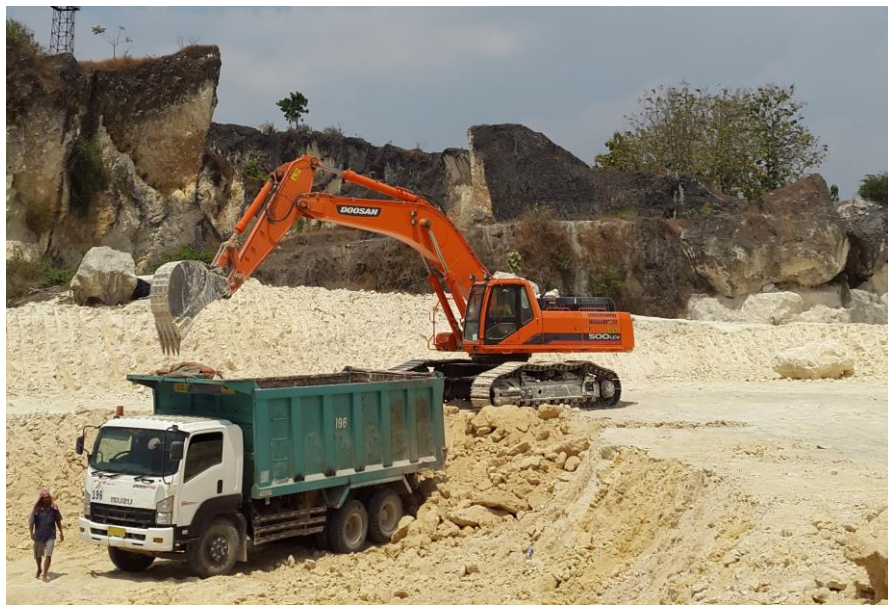
Gambar 2.1 Proses Loading Material dengan Excavator ke Dump Truck
