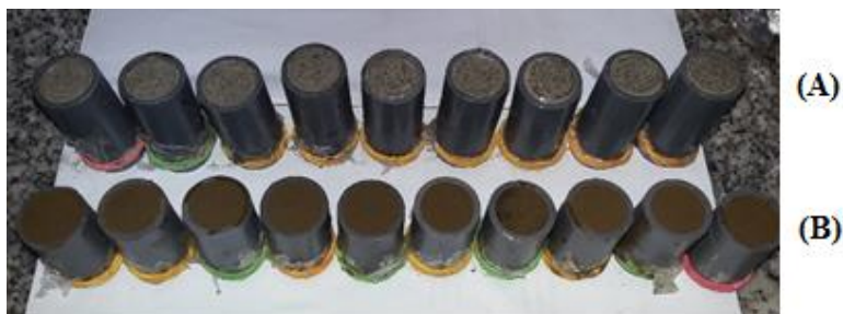
Gambar 4. 9 Proses pencetakan dan pemeraman pasta geopolimer dalam cetakan silinder dengan dengan abu layang (A) Paiton 1-2, (B) Holcim
