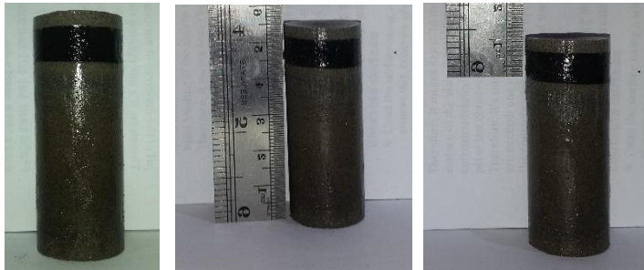
Gambar 4. 10 Foto Geopolimer dari abu layang PLTU Paiton 1-2 dengan metode non-impregnasi (langsung)
