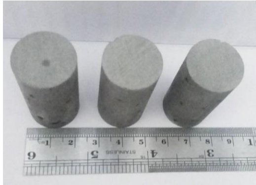
Gambar 4. 14 Foto geopolimer yang telah diratakan permukaan atas dan bawah.
