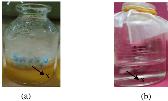
Gambar 4.5. Pertumbuhan Isolat Jamur pada (a) Medium Standar dan (b) Medium MSM+Plastik Setelah 10 Hari Masa Inkubasi yang ditunjukkan pada simbol x.
