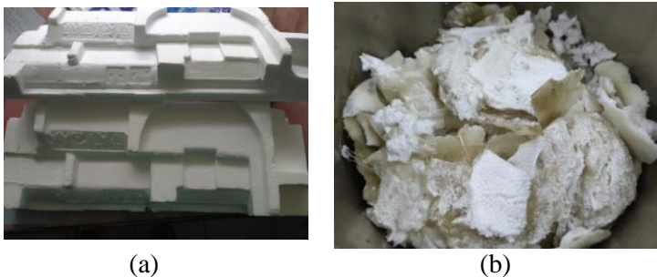
Gambar 4.8 (a) Limbah PS berupa styrofoam , (b) Styrofoam yang dipadatkan
