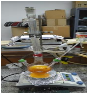
Gambar 4.1 Rangkaian alat reflus sintesis biodiesel
