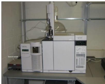
Gambar 2.14 Instrumen GC-MS (Pavia dkk., 2006)
