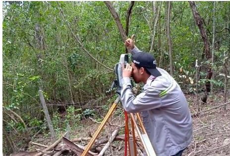
Gambar Lampiran 1.3 Pengukuran Titik Kontrol pada Situs 5 dengan Menggunakan Total Station Gowin TKS202
