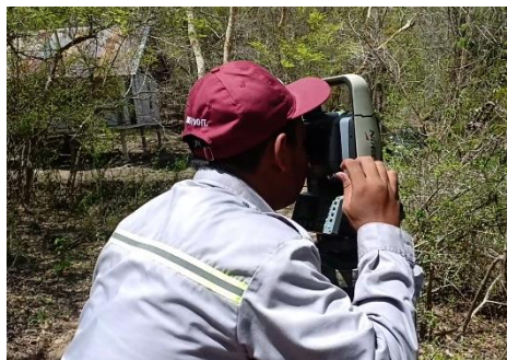
Gambar Lampiran 1.4 Pengukuran Titik Kontrol pada Situs 4 dengan Menggunakan Total Station Gowin TKS202
