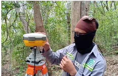
Gambar Lampiran 1.2 Pengukuran Titik Kontrol pada Situs 5 dengan Menggunakan GPS Geodetic Hi-Target
