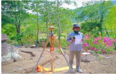
Gambar Lampiran 1.1 Pengukuran Titik Kontrol pada Situs 2 dengan Menggunakan GPS Geodetic Hi-Target
