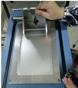
Proses coating material aktif pada Al-foil
