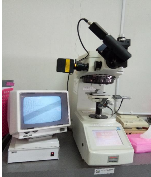
Gambar 3.6. Pengujian kekerasan paduan aluminium hasil coran dengan Microhardness Vicker's
