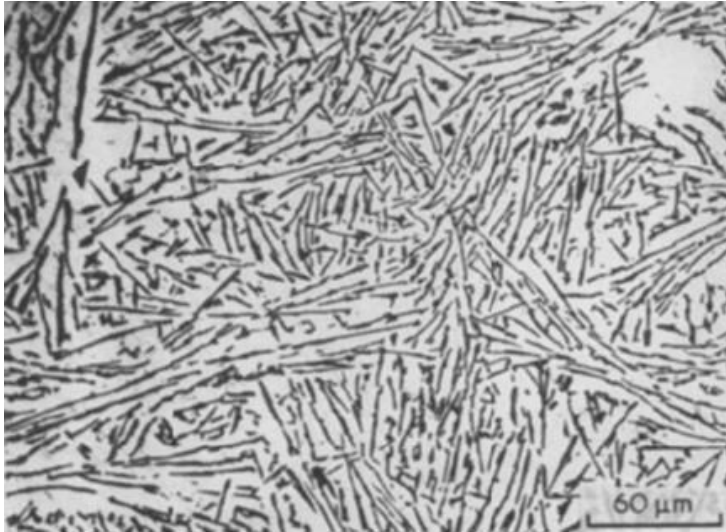
Gambar 2.5. Mikrostruktur paduan eutektik Al-Si, etsa 0,5% HF dan perbesaran 750x ( ASM Metals Handbook , 1988).
