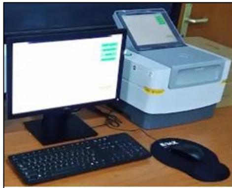
**Gambar 3.6** Alat pengujian XRF
