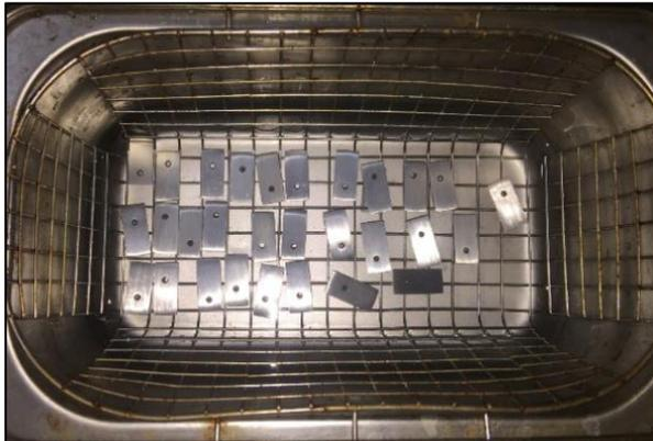
**Gambar 3.3** Pembersihan dengan Ultrasonic Cleaner
