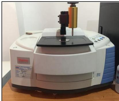
**Gambar 3.9** Alat pengujian FTIR
