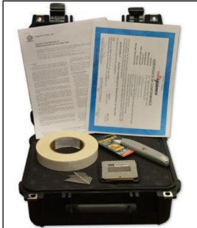
**Gambar 3.13** Alat pengujian *Tape-test*
