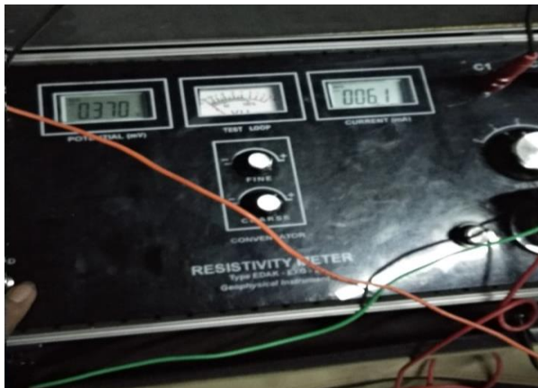
Gambar 6.2 Pengukuran resistivitas sampel tanah
