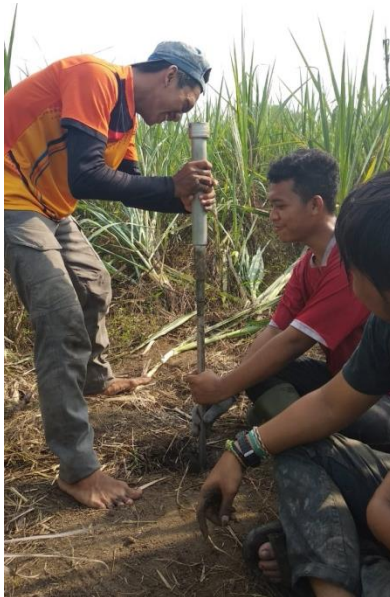
Gambar 6.4 Pengambilan sampel tanah dengan menggunakan alat Hand-Auger
