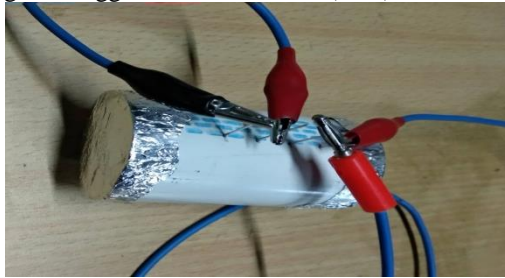
Gambar 3.3 Uji Resistivitas sampel tanah
