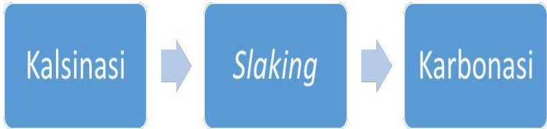
Gambar III.10 Skema Proses Pembuatan PCC
