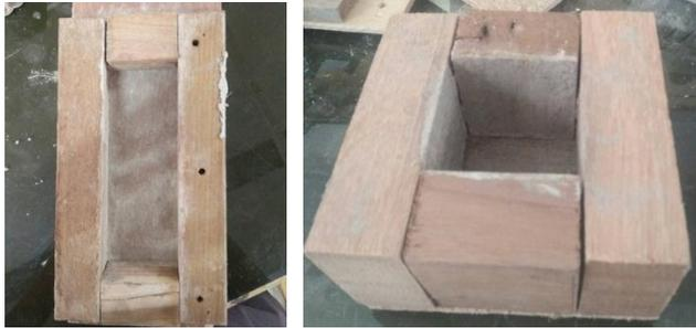
**Gambar 3.2** Cetakan pembuatan spesimen (Dokumentasi Pribadi)
