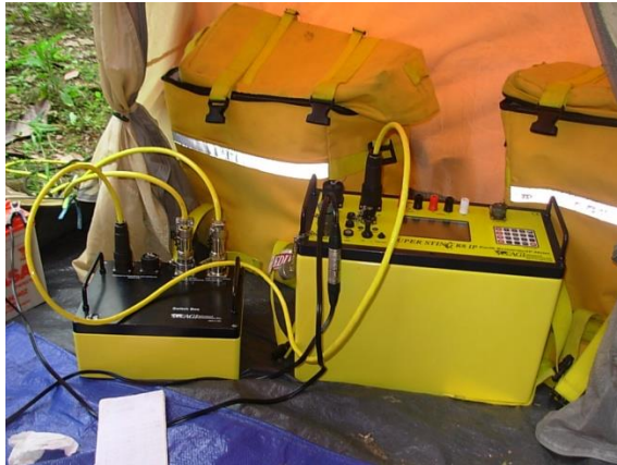
Gambar 3.3. Foto Alat Geolistrik Supersting R8/IP-56 Saat Akuisisi Data di Dalam Tenda (Dokumentasi GEOTEK LIPI, 2011)
