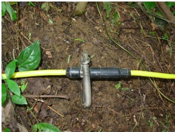
Gambar 3.4. Gambar Elektroda yang Tersambung pada Kabel, Transmitter Arus dan Atau Receiver Tegangan (Dokumentasi GEOTEK LIPI)
