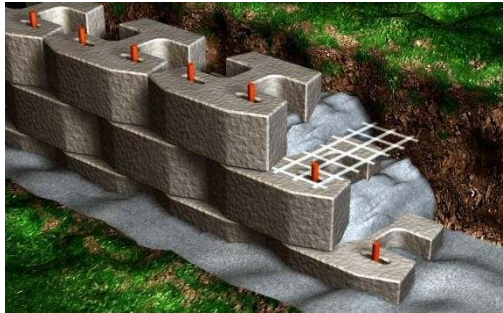
Gambar 2.15 Pemasangan dinding penahan beton Segmental dan Geogrid
