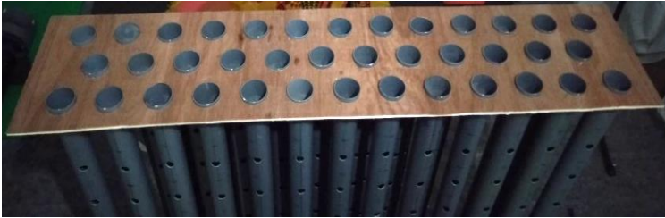
Gambar 3.4. Panel Sonic Crystal dengan Konfigurasi Triangular 3 Layer
