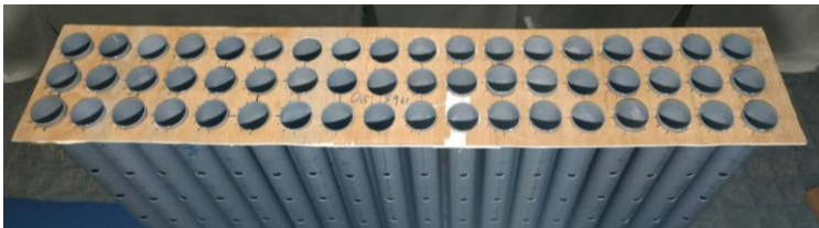
Gambar 3.3. Panel Sonic Crystal dengan Konfigurasi Square 3 Layer
