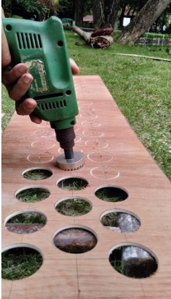
Proses melubangi pada triplek
