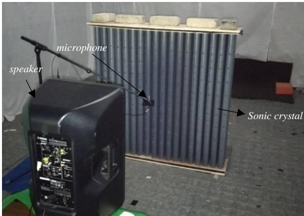
Gambar 3.6. Pengukuran Ruang Kosong (a) Pengukuran Langsung dengan Panel Sonic Crystal (b)
