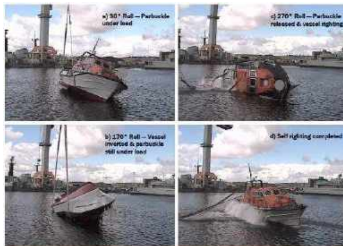
Gambar II.12 Kapal dengan inherent self-righting
