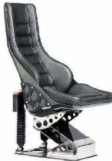
Gambar IV.35 Contoh Suspension Seat pada High Speed Craft (HSC) (Sumber: Olausson, 2015)
