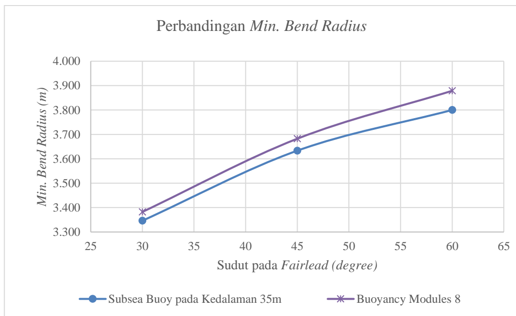
Gambar 4.29 Grafik Perbandingan Min. Bend Radius antara Penggunaan Subsea Buoy dengan Buoyancy Modules
