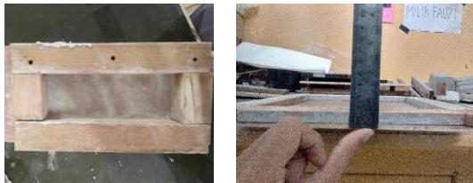
Gambar 3.2 Cetakan pembuatan spesimen
