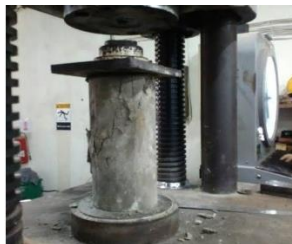
Gambar 5.10 : Uji kuat tekan beton.
