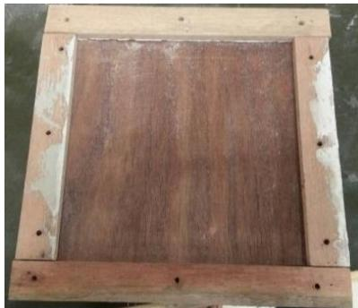
**Gambar 3. 4** Cetakan Pembuatan Spesimen
