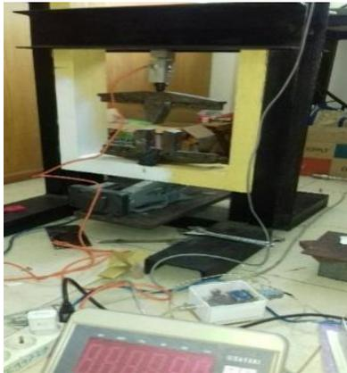
**Gambar 3. 8** *Alat Uji Bending*
