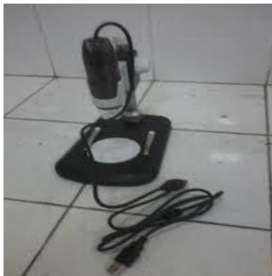
**Gambar 3.6** Alat Uji Mikroskop USB
