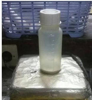
Gambar 3.1 Pengadukan sampel pada reaktor botol PP
