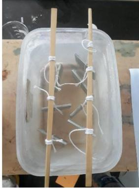
**Gambar 3.10** Pengujian Laju Korosi dengan Metode *Immerse* (dok. pribadi)
