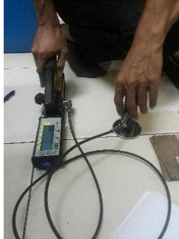
**Gambar 3.9** Pengujian Kekuatan Lekat Lapisan Seng dengan Metode *Pull-off* (dok. pribadi)
