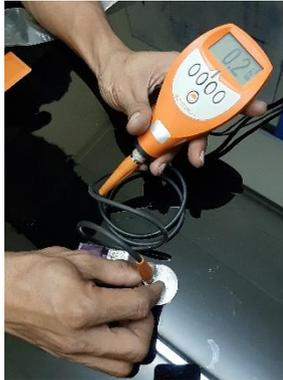
**Gambar 3.6** Proses Kalibrasi Alat Ukur Ketebalan DFT (dok. pribadi)
