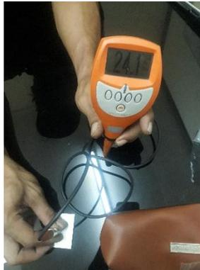
**Gambar 3.7** Pengukuran Ketebalan Lapisan *Coating* Seng (Zn) Menggunakan Alat Uji Ketebalan DFT (dok. pribadi)
