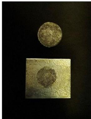
**Gambar 4.6** Hasil Pengujian *Pull-off* Lapisan Seng
