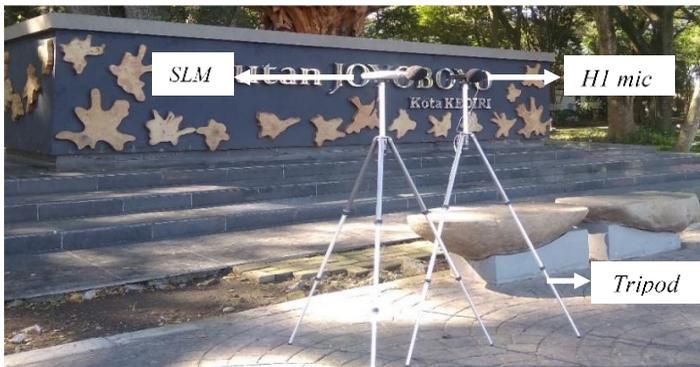
**Gambar 4. 3** Konfigurasi sistem pengukuran parameter akustik objektif
