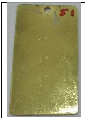
Gambar 4.1 Acuan Standard Minimal Visual Hasil Pelapisan Elektroplating Kuningan dengan Kondisi Operasi 27^{\circ}\text{C} dengan Waktu 120 Detik
