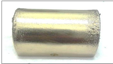
Gambar 4.12 Acuan Standard Bending Test Hasil Pelapisan Elektroplating Kuningan dengan Kondisi Operasi 27°C dengan Waktu 120 Detik
