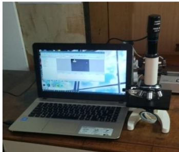
Gambar 3.8 Mikroskop dan alat bantu pengambilan gambar berupa laptop dan kamera.
