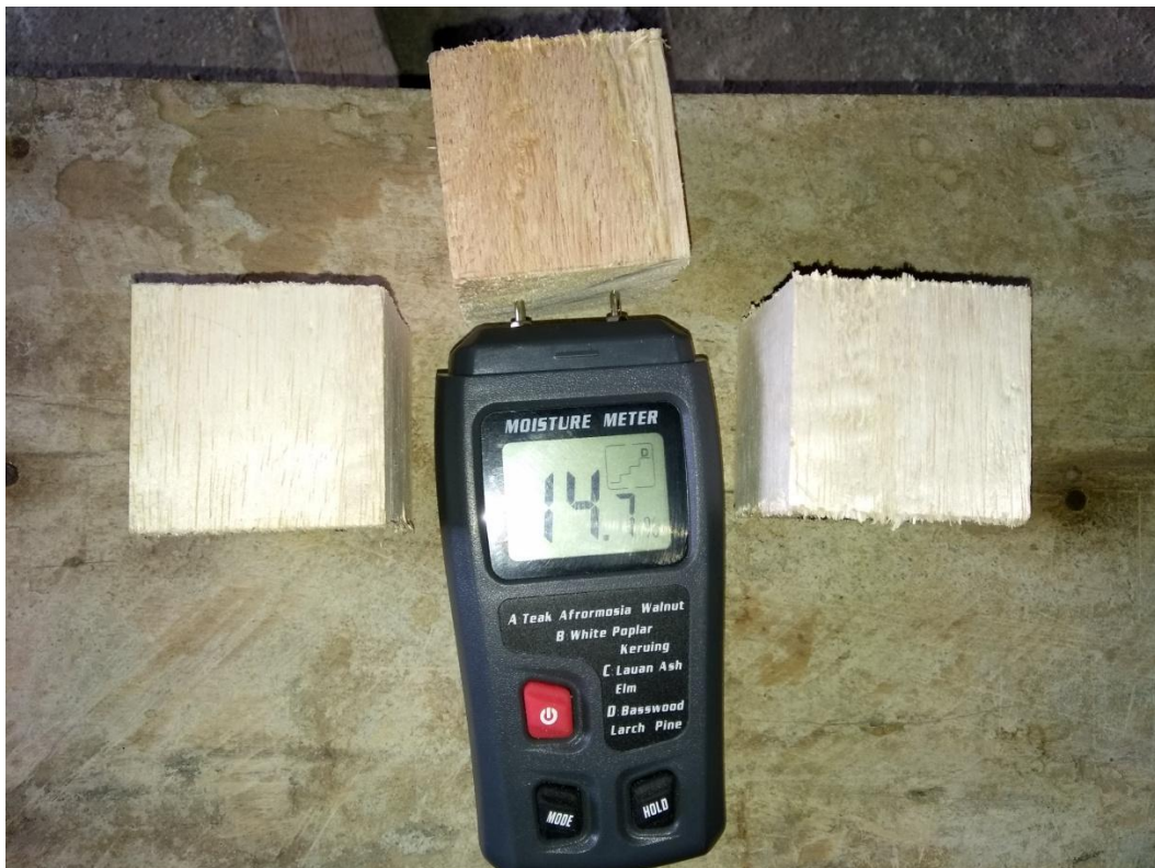
Gambar 4.1 Pengukuran Kadar Air Kayu pada Sengon Laut
