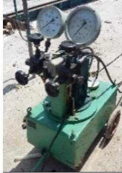
Sumber: Dokumen Pribadi Gambar 4. 77 Stressing Pump
