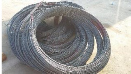
Gambar 4. 63 Kabel Strand di Lapangan
