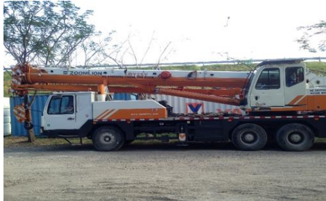
Sumber: Dokumen Pribadi Gambar 4. 45 Mobile Crane
