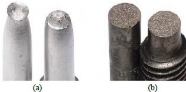
Gambar 2. 12 (A) Patah Ulet ( Cup dan Cone ) pada Aluminium dan (B) Patah Getas pada Mild Steel . (Callister, 2014)
