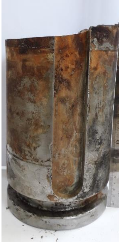
Gambar 3. 2 Circulating Water Pump Shaft yang Mengalami Patah (Dokumen Pribadi)
