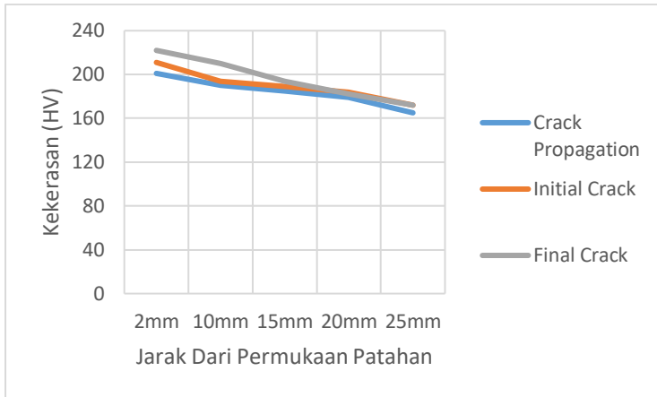
Gambar 4. 13 Perbandingan Kekerasan pada Daerah Initial Crack , Propagation , dan Final Crack
