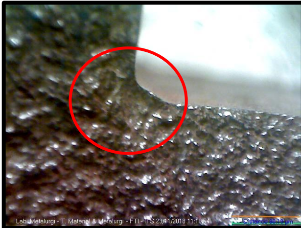
Gambar 4. 4 Titik Initial Crack
