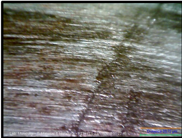
Gambar 4. 7 Crack pada Daerah Patah Cepat
