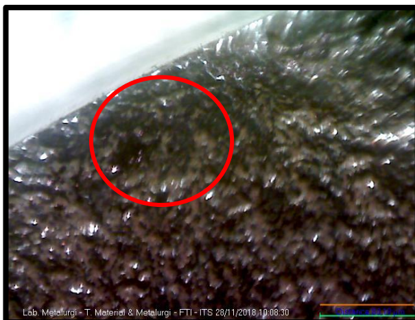
Gambar 4. 5 Titik Defect dan Rambatan Retak
