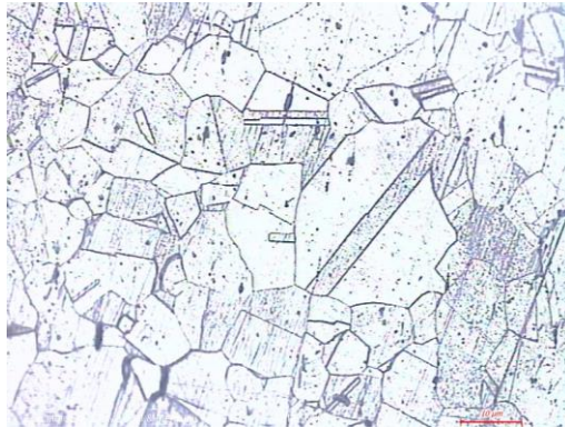
Gambar 4.8 metallog Struktur Mikro Daerah Jauh dari Permukaan Patahan dengan Pembesaran 1000x
