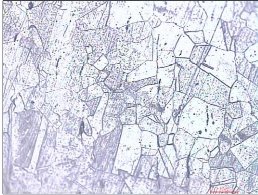
Gambar 4. 9 Struktur Mikro Daerah Dekat dari Permukaan Patahan dengan Pembesaran 1000x
