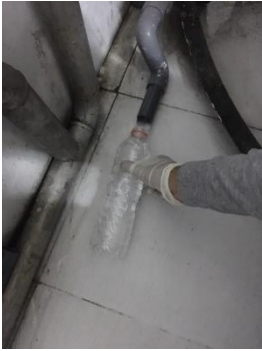
Pengambilan sampel pada efluen reverse osmosis + ozone
