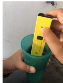
Analisa sampel dengan pH meter
