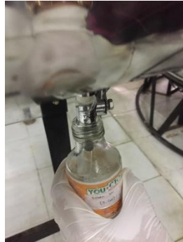
Pengambilan sampel pada efluen lampu UV
