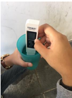
Analisa sampel dengan TDS meter
