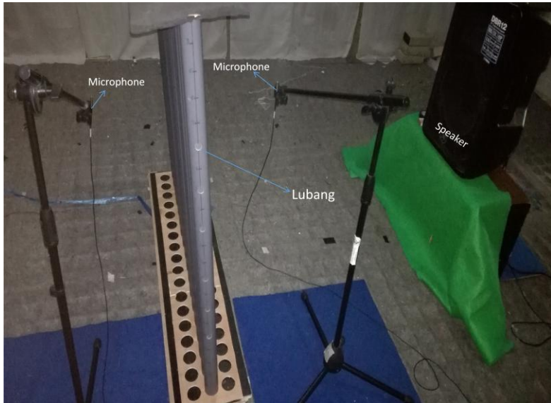
Gambar 3. 11 Proses pengukuran sonic crystal pada pipa PVC
