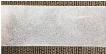
Gambar 4. 2 Spesimen Kaca Borosilikat yang Telah Dideposisi
