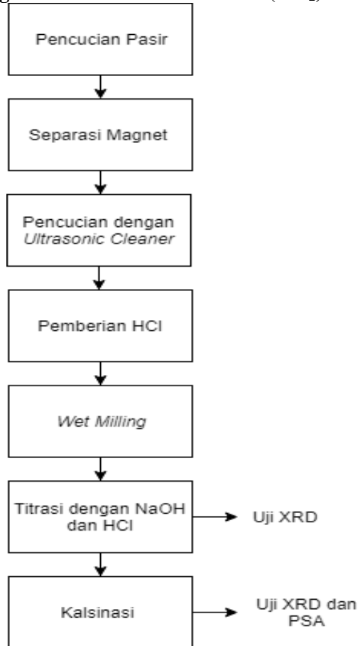
Gambar 3.8 Diagram Alir Sintesis Pasir Silika
