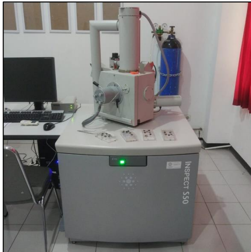
Gambar 3.3 Alat uji SEM-EDX Inspect S-50 (Dokumen Pribadi, 2019)
