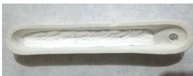
Gambar 4.2 Sampel ZSM-5 Setelah Proses Kalsinasi 550^\circ\text{C}
