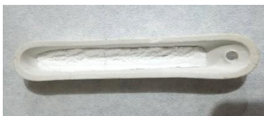
Gambar 4.1 Sampel ZSM-5 Sebelum Proses Kalsinasi
