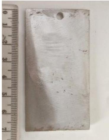
**Gambar 4. 1** Spesimen Baja AISI 1020
