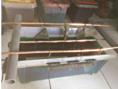
**Gambar 3.9** Rangkaian Elektroplating Nikel
