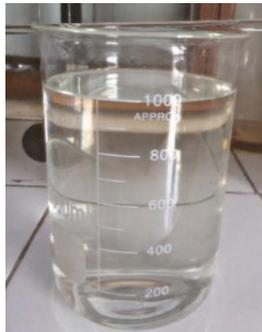
**Gambar 3.3** Larutan Elektroplating Kuningan
