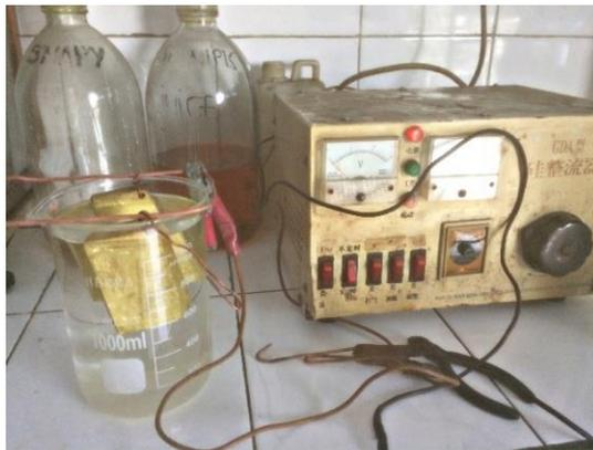
**Gambar 3.8** Rangkaian Elektroplating Kuningan
