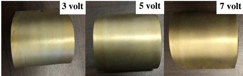
**Gambar 4.9** Hasil Uji *Bending* Spesimen Elektroplating Kuningan Tanpa Lapisan Dasar dengan Variasi Voltase
