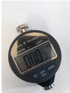
Gambar 3. 19 Alat uji kekerasan Durometer (Astm, E2583).
