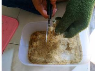
**Gambar 3.11** Pemotongan Serat (dok. pribadi)
