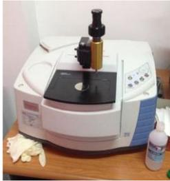
**Gambar 3. 7** Mesin FTIR (dok. pribadi)
