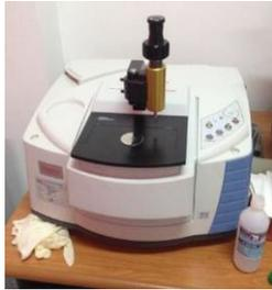
**Gambar 3. 17** Alat Uji FTIR
